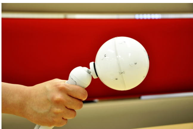
音源探査・可視化装置のセンサー
