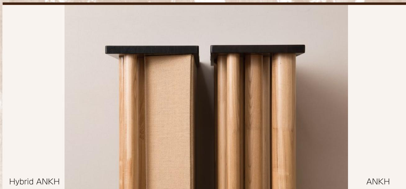
Hybrid ANKH は従来の ANKH と同様のサイズ内に、ファブリック(布)で囲まれた吸音のためのスペースを備えています。ファブリックはレコーディングスタジオなどで壁や天井の音響処理用仕上げ材として用いられる生地を採用し、ファブリック内部には吸音材とともに、従来の ANKH シリーズと同様に太さの異なる円柱を配置しています。一般的に吸音材を多用すると、音が詰まり艶やかさや伸びやかさが損なわれるという側面があります。Hybrid ANKH は、過度な高域の吸音を押さえて設計されていることに併せ、特許技術である柱状拡散効果により単体の吸音材にありがちな悪影響をカバーし、緻密な響きを損なうことなく低～中域のふくらみや不明瞭さを改善させます。
