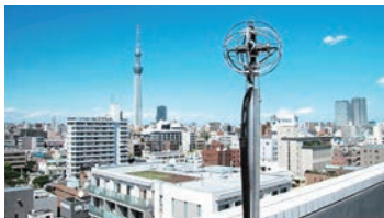
音源探査識別装置
