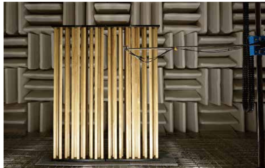
無響室における反射特性の測定・評価
