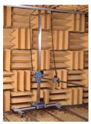
全軸自走式ですので、可動範囲の拡張が容易です。特に水平方向はレールを数本連結することで5m以上可動させることができます。
