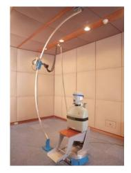
円狐型トラバースと回転椅子を利用して、音源の位置決めを精度良く行い、HRTF計測の自動化をサポートします。
